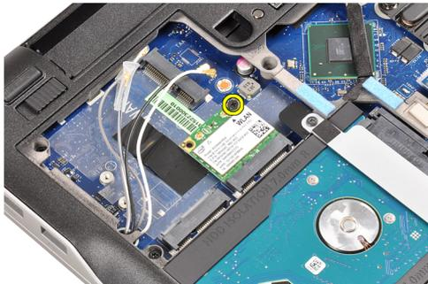
5. Deslize e remova a placa WLAN para fora do seu slot na placa de sistema.
