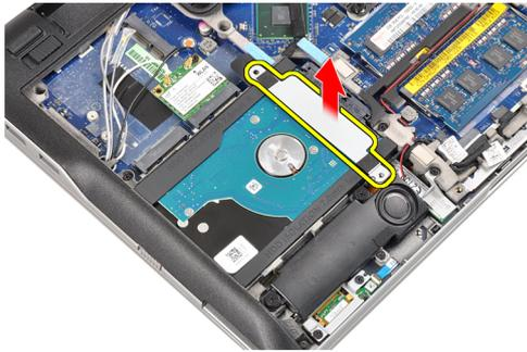
5. Use uma chave de fenda plana para levantar a borda do disco rígido.
