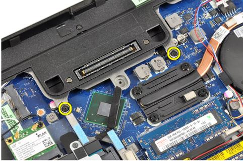
4. Vire o computador e remova os parafusos que prendem o teclado.
