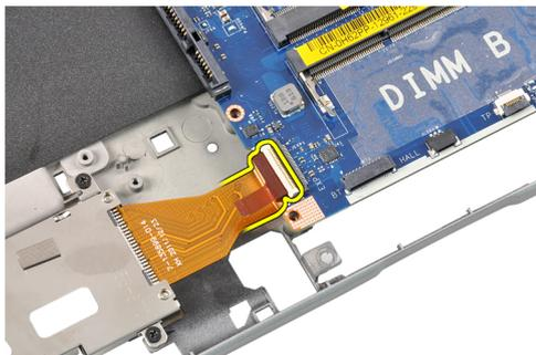
5. Desconecte o cabo do conector de alimentação.
