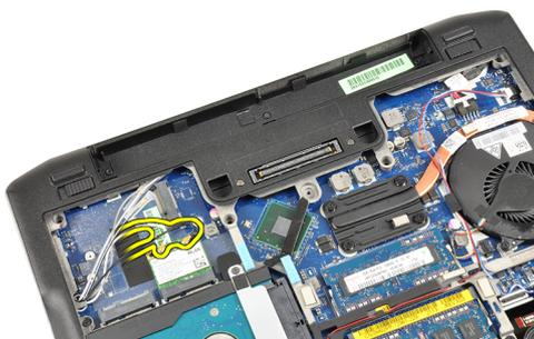
5. Remova os parafusos que prendem o suporte de LVDS (low-voltage differential signaling) ao computador.
