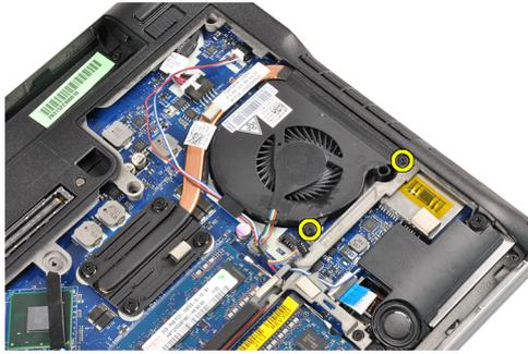
5. Levante e remova o ventilador do dissipador de calor.
