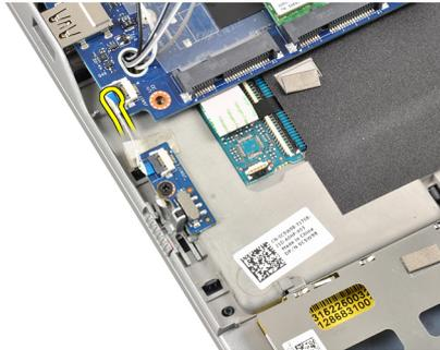
4. Remova o parafuso que prende a placa de switch do WiFi ao computador.
