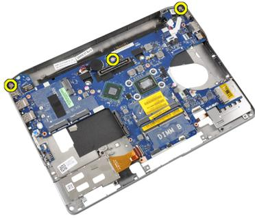
7. Levante a borda esquerda da placa de sistema e eleve-a em um ângulo de 45 graus.
