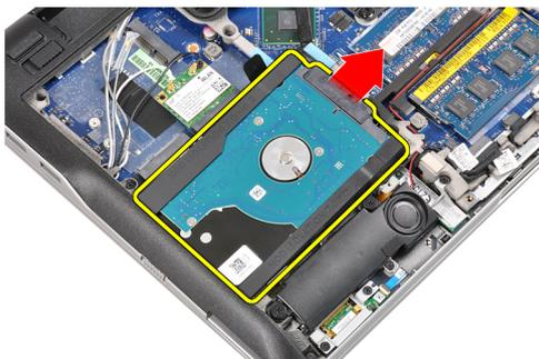
7. Remova o conector do disco rígido do disco rígido.
