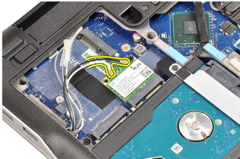
4. Remova o parafuso que prende a placa WLAN ao computador.
