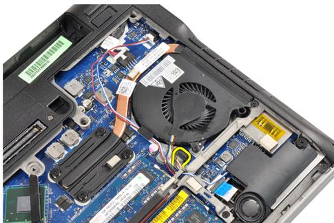
4. Remova os parafusos que prendem o ventilador do dissipador de calor ao computador.
