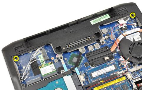
4. Desconecte quaisquer cabos de antena que possam estar conectados às soluções sem fio e remova-os dos canais de roteamento.
